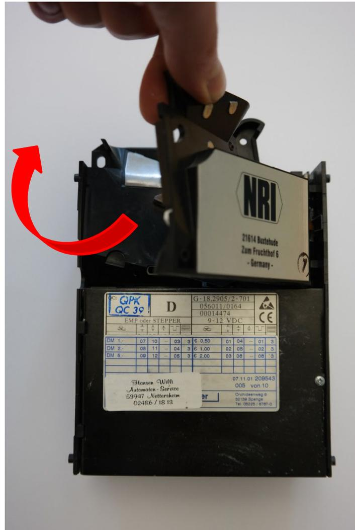
Sollten Münzen im Automaten steckengeblieben sein, kann man sie durch Öffnen der Klappe im Münzprüfer innen entfernen.
