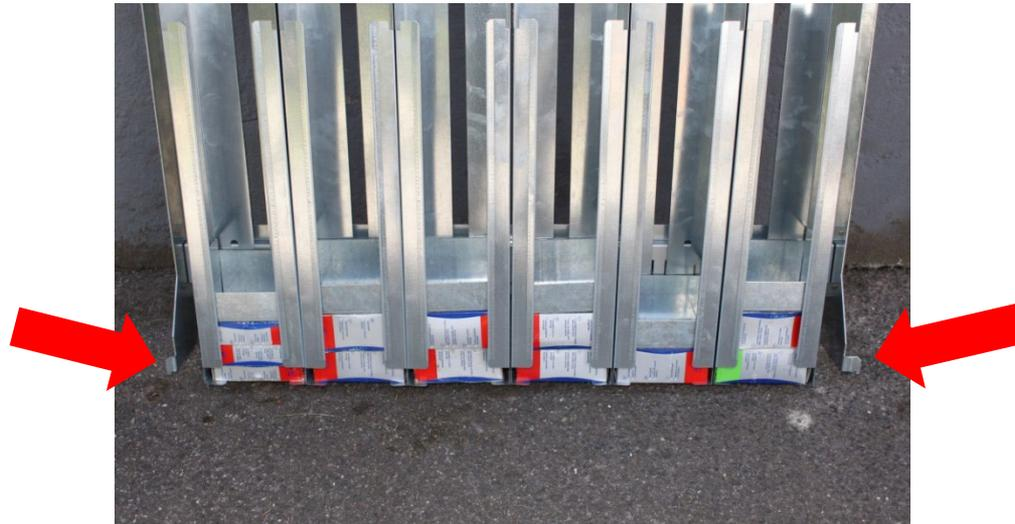
Aufnahme für Schachtpaket links und rechts, die Nasen des Schachtpaketes müssen hier aufliegen. Das Schachtpaket muss mittig montiert ohne Kraftaufwand kippbar sein.
