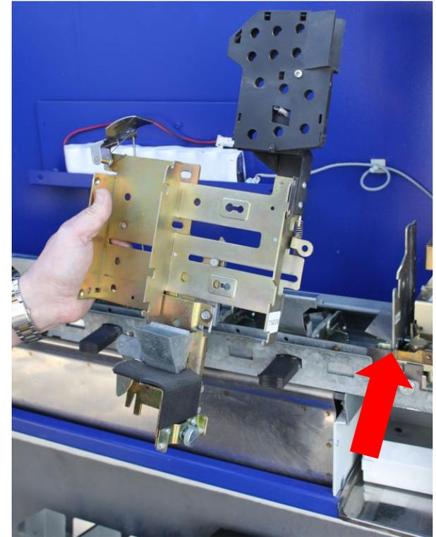
Münzturm entnehmen, beim Zusammenbau die Aufnahmepunkte in die dafür vorgesehenen Aufnahmevorrichtungen einsetzen
