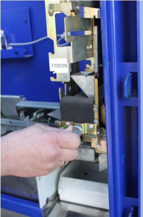
Verschraubung des Münzturms lösen
