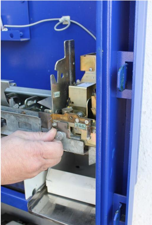
Rändelschraube lösen und Kegelscheibe entfernen, um das Abdeckblech lösen zu können
