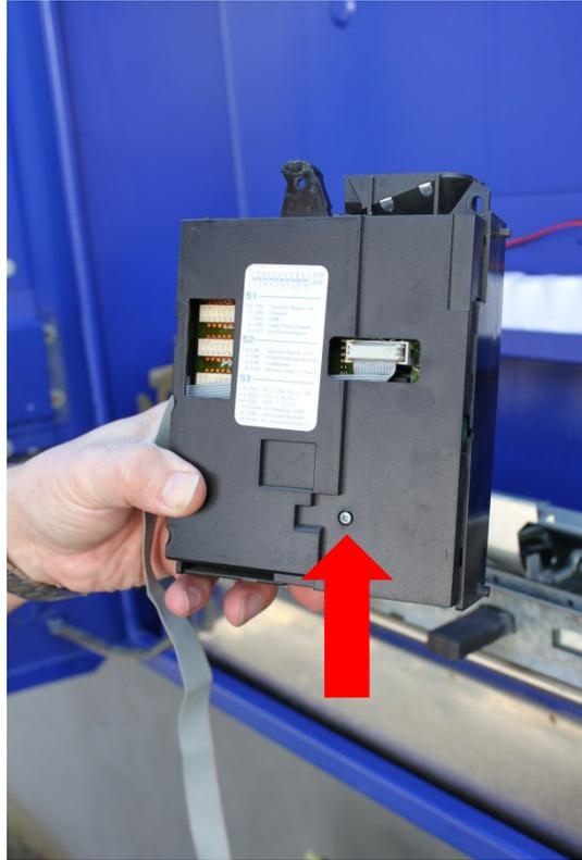
Bei einigen Schlauchautomaten wird die Batterie im Münzprüfer angeschlossen, dazu muss der Münzprüfer wie folgt geöffnet werden:
