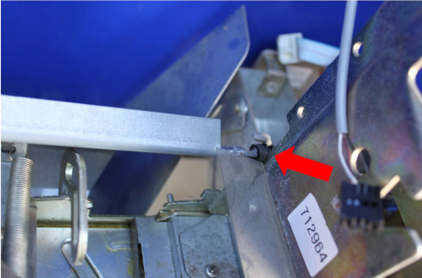
Ein Diebstahlblech kann an den 2 dafür vorgesehenen Befestigungen optional eingebaut werden.
